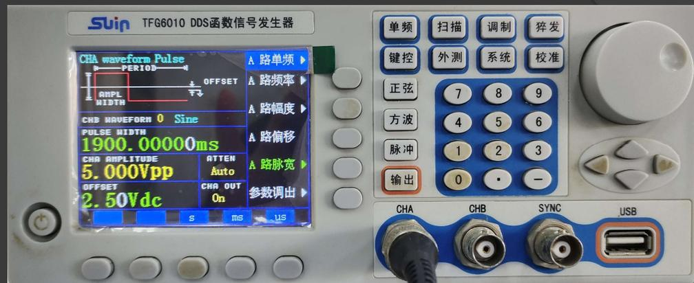
函数信号发生器输出的脉冲作为单稳态的触发信号：
