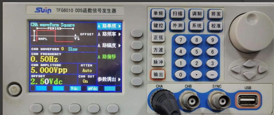
函数信号发生器输出的方波作为单稳态的触发信号:
